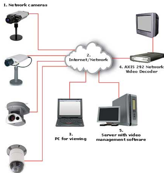
รูปภาพ 2-1 ตัวอย่างลักษณะของระบบตรวจสอบผู้บุกรุกหรือระบบเฝ้าดู (Surveillance System)
